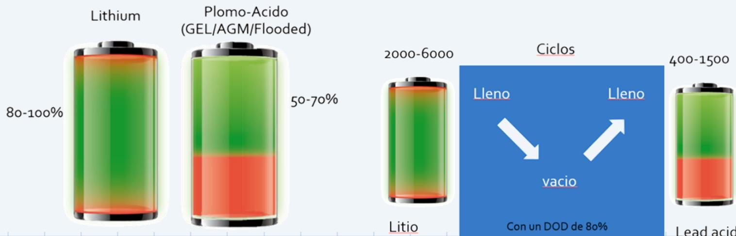
Las [batería de Litio](#) tienen un peso mucho más bajo en comparación con las baterías de [AGM/GEL](#). Por ejemplo, una batería de [AGM](#) de [100 AH de la marca Ultracell](#) pesa 30.5 KG, una batería de LITIO de 100 Ah pesa 13.6 KG que es más del 50% del peso. Las baterías de litio proporcionan una mayor bajada de peso.
